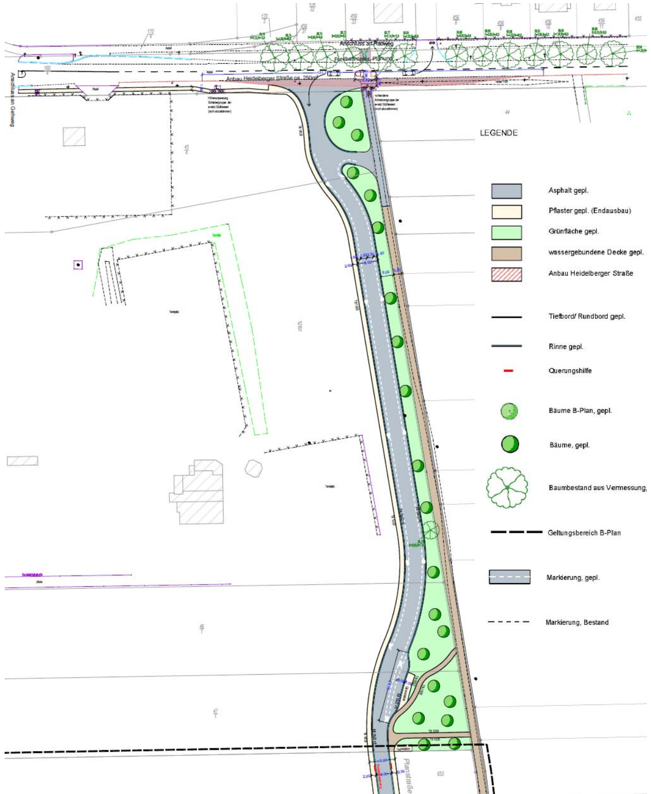
Abb.5: Lageplan Erschließung Wohnanlage östlich der Ringstraße – 2. Abschnitt
